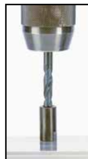
No. 1 Forare il filetto spezzato tramite la bussola
